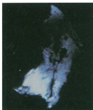
Abb. 24. Chemical-shift-selektives Lipidprotonenbild der gleichen Arterienprobe wie bei Abbildung 23 b. Wegen der kurzen Spin-Gitter-Relaxationszeit der Lipidprotonen konnte bei dieser Messung die Repetitionszeit TE auf 200 ms herabgesetzt werden. Die übrigen Parameter sind identisch mit denen für Abbildung 23 b.
