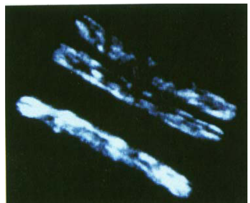
Abb. 30. Spin-Echo-Bild aus 20 Aufnahmen von glasfaserverstärkten Epoxidharzstäben mit unterschiedlichem Wassergehalt. Pixel-Auflösung 138 \mu\text{m} . Schichtdicke ca. 1 mm, TE = 4.5 ms, TR = 1 s.
